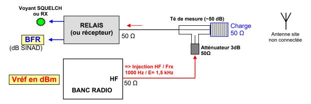
Augmenter le niveau HF du banc radio jusqu'à obtenir le déclenchement du Squelch (ou 20 dB SINAD sur la BFR). Lire la valeur de Référence en dBm Vréf.
